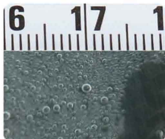
DU-1500により発生した水中の微細気泡 (チンダル現象)
