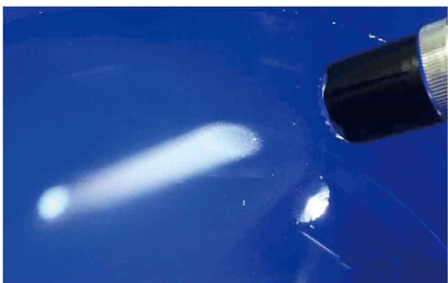
DU-1500により発生した水中の微細気泡 (チンダル現象)
